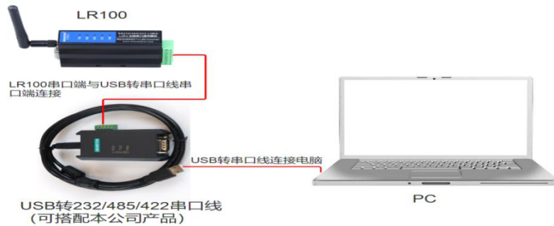
图 4.2 LORA 模块参数设置接线示意图
